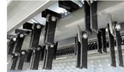
В качестве дополнительного оборудования доступны дефлекторные пластины с электрорегулировкой. Регулирование распределения соломы всегда можно осуществлять из кабины.
