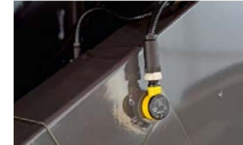
Для постоянного отслеживания качества обмолота, а также быстрого и простого реагирования на изменение условий уборки урожая можно использовать камеру контроля домолота.
