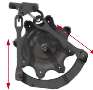
Дека сепаратора установлена под сепаратором Multi-Crop Separator (MCS). Такой режим позволяет повысить эффективность сепарации при уборке длинностебельных культур в условиях высокой влажности, обеспечивая высокую производительность даже в самых сложных погодных условиях.
