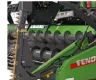
Оptionальный шнек для рапса увеличивает поток массы к наклонной камере при работе с высокостебельными культурами, повышая производительность комбайна.
