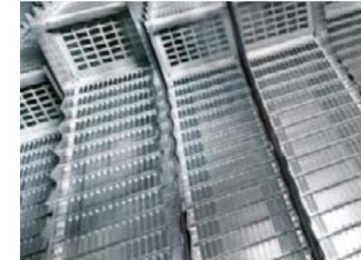
Регулируемая пластина днища с профилированной поверхностью устанавливается в стандартной комплектации и обеспечивает равномерную длину измельченной соломы.
