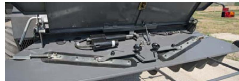
Также в качестве опции доступны электрически регулируемые дефлекторы, поэтому вы сможете настроить направление разбрасывания прямо из кабины.
