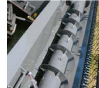
Подающий битер PFR (Power Feed Roller) обеспечивает равномерное перемещение массы от жатки к наклонной камере.
