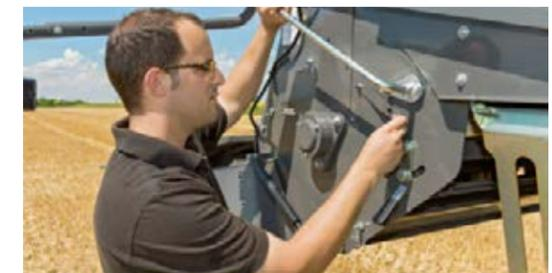
Для быстрого и простого переключения между валкованием и разбрасыванием нужно просто изменить положение рычага.
