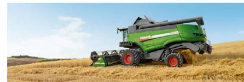
Чтобы уменьшить износ узлов комбайна из-за грязи, попадающей во внутренние компоненты техники, в наших моделях комбайнов для уборки риса используются специальные очень износостойкие материалы – особенно для элементов, находящихся в непосредственном контакте с массой.
