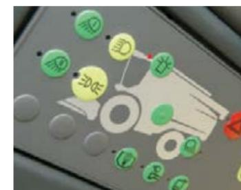
Оптимальный контроль задействованного рабочего освещения на удобной панели с подсветкой.
