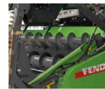
Оptionальный шнек для рапса увеличивает поток массы к наклонной камере при работе с высокостебельными культурами, повышая производительность комбайна.
